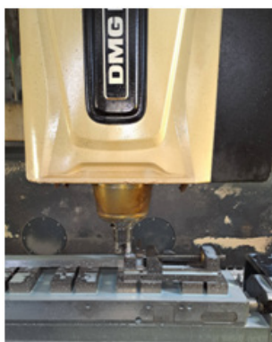
Рис. 3. Обробка поверхні зразків на ЧПУ DMG MORI-1100
