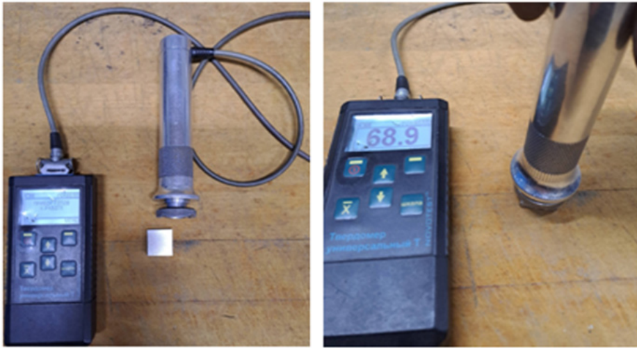
Рис. 5. Вимірювання твердості на ультразвуковому твердомірі NOVOTEST T
